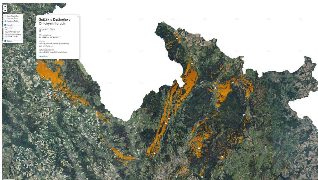
Obr. 6 Náhled GUI mapového portálu potenciálně rizikových oblastí a lokalit s detailem zobrazení digitální signální mapy rizik azbestu. Oranžově jsou vyznačena horninová tělesa bazických a ultrabazických hornin v části lužické a moravskoslezské oblasti Českého masivu. Patrná je legenda bodové vrstvy lokalit a interaktivní přístup ke kartě lokality.
