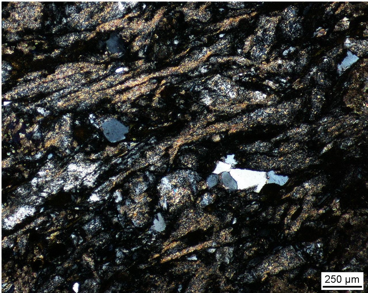
Obr. 16893/21. Výrazně přeměněná základní hmota, tvořená jemnozrnnými agregáty sericitu a chloritu. Dobře viditelná je plošně paralelní (břidličnatá) textura horniny (XPL).
