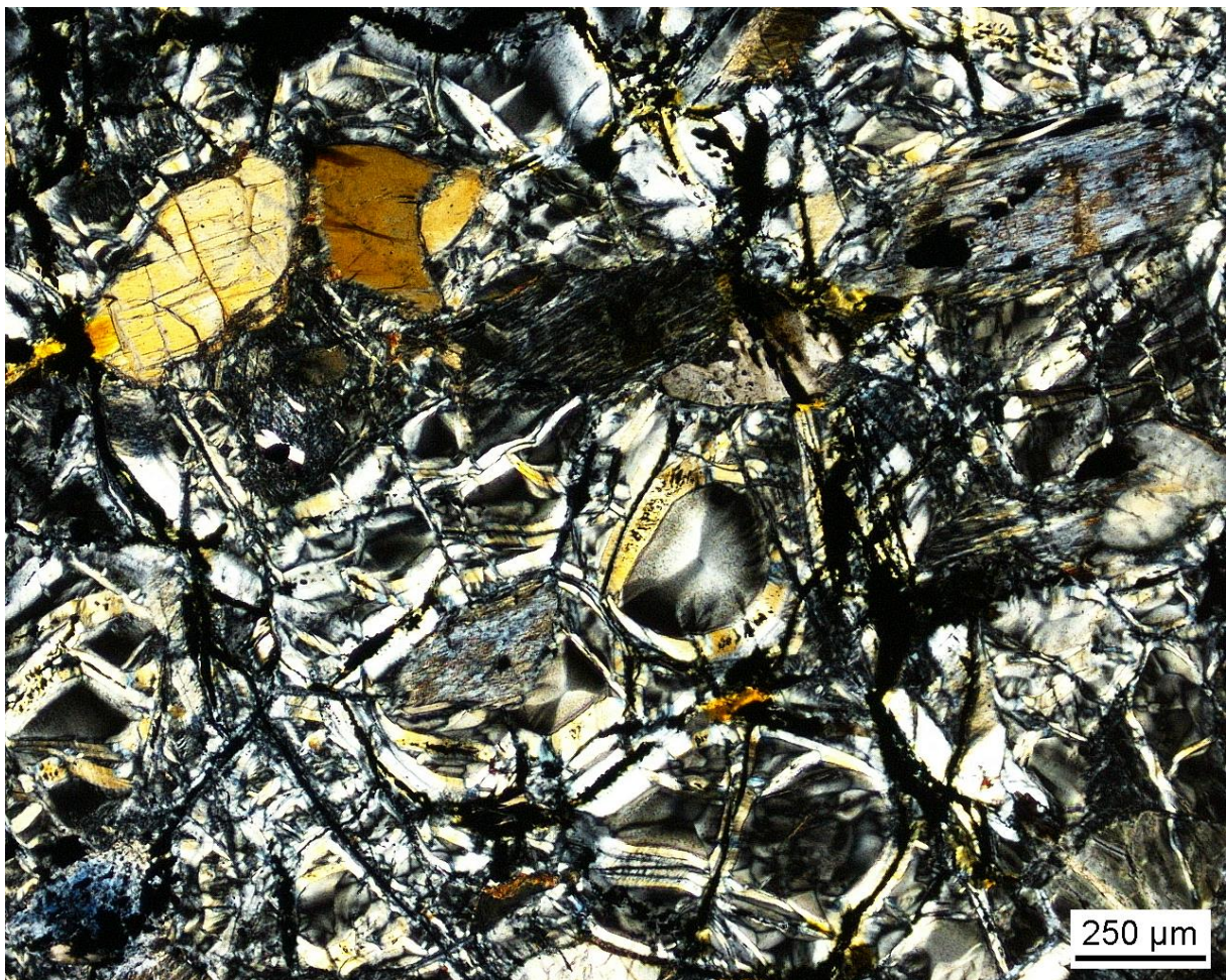
Obr. 16951/26. Pokročilá serpentinizace původního peridotitu, dokumentovaná přítomností lupenitého až lístkovitého antigoritu a lizarditu, vznikajících přeměnou olivínu. V reliktech jsou dochovány primární amfiboly, hojná je opakní fáze (XPL).
