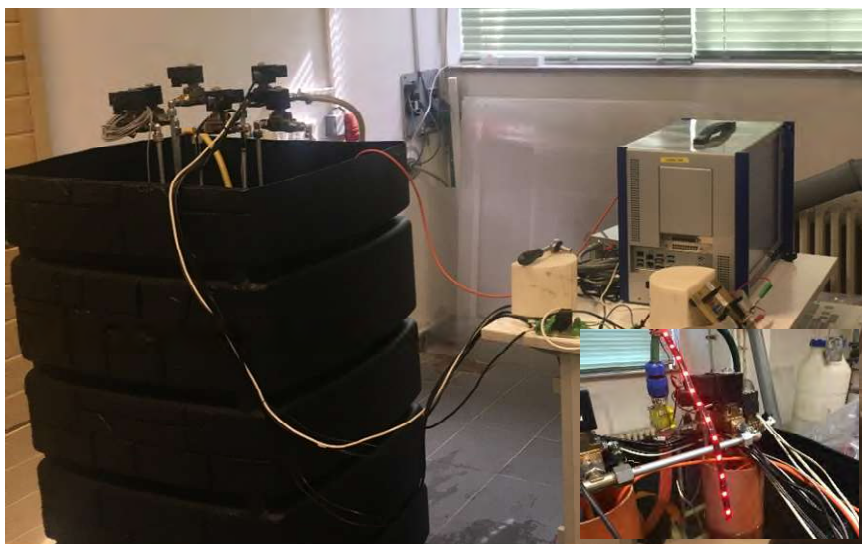
Obr. 6 Model zařízení v chodu, na obrázku je znázorněn model zařízení v chodu, černá nádoba naplněná vodou reprezentuje bazén, ve kterém jsou uloženy válce. Válce se postupně plní vodou a voda je vytlačována stlačeným vzduchem na turbínu. Na pravé straně obrázku je řídicí jednotka, která udržuje chod zařízení a snímá hodnoty tlaku a teploty vzduchu.
