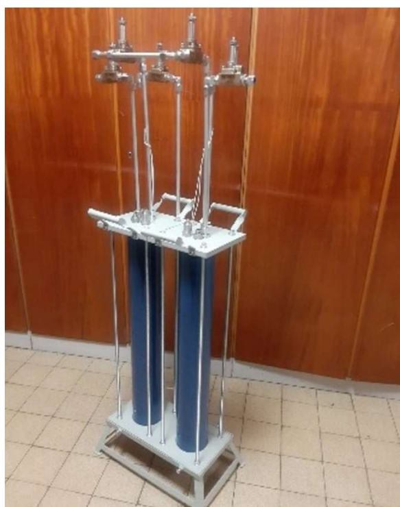
Obr. 5 Model sestaveného zařízení, Na obrázku je sestavený model zařízení. Jsou vidět elektromagnetické ventily, které slouží k řízení chodu zařízení. Tyto ventily kontrolují napouštění a vypouštění stlačeného vzduchu a chod vody hnané stlačeným vzduchem na vodní turbínu.
