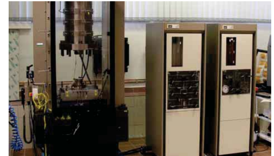
Víceúčelový servohydraulický zatěžovací systém s triaxiální komorou
