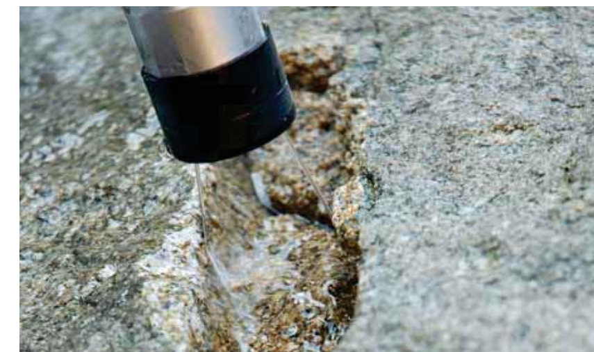
Drážka vytvořená rotačním pulzujícím vysokorychlostním vodním paprskem v žulovém masivu (lom Erlich, Žulová)
