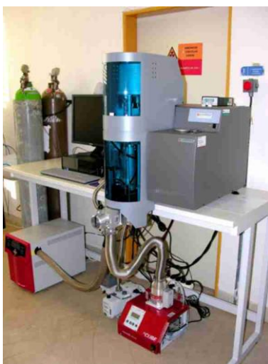
Termální analyzátor SETSYS TG-DTA/DSC 24 s hmotovým spektrometrem
