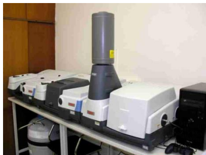
FT-IR spektrometr NICOLET 6700 s FT-Ramanovým modulem NICOLET NXR
